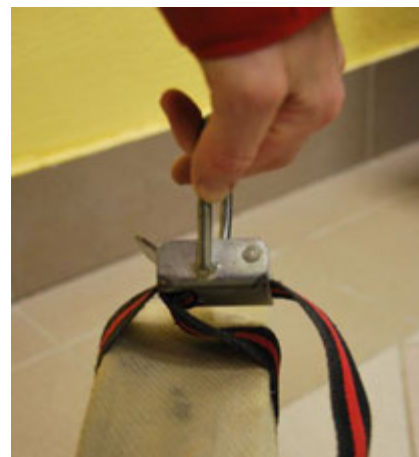
NEPRAVILNO ZAPET CEVNI NOSILEC
